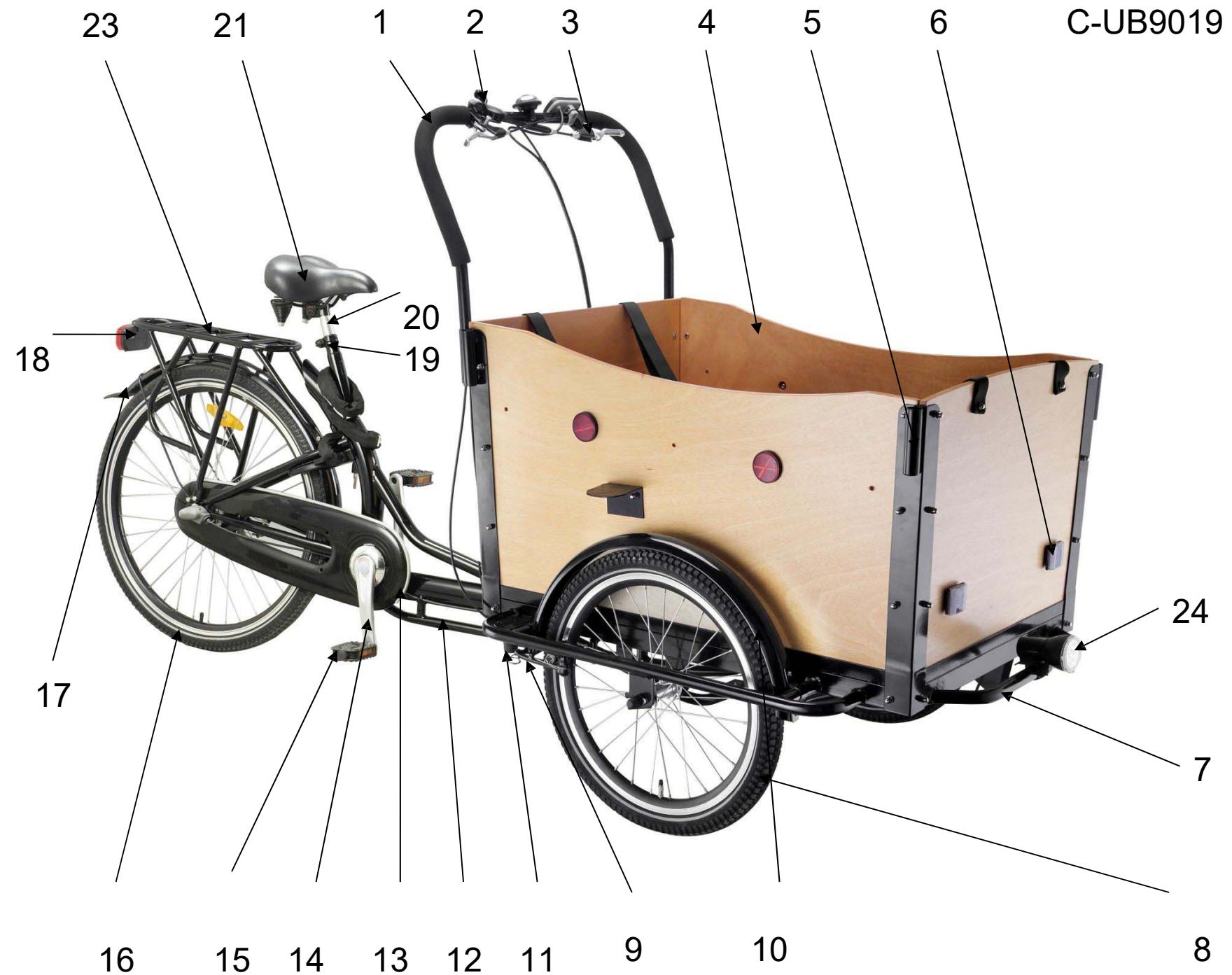
1. Styre og håndtak 2. Girsikifter 3. Bremsespak 4. kasse
